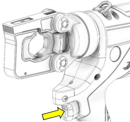
Mettre le connecteur à sertir avec le câble à sertir entre les matrices.
