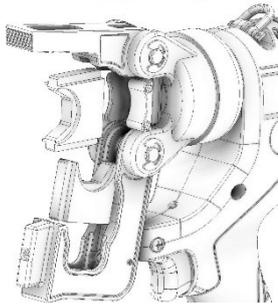
Sélectionner le jeu de matrices. Ouvrir la tête puis insérer le jeu de matrices dans la tête jusqu'à l'encliquetage dans les poussoirs à bille.
