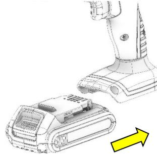
Glissez la batterie à fond dans l'outil jusqu'au clic de verrouillage.
