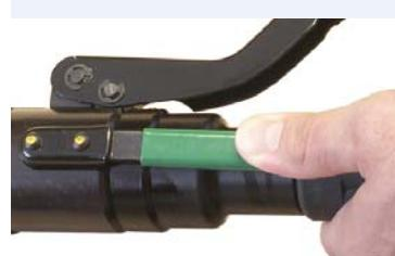
Déclenchement automatique avec "clic" audible en cas de surcharge. Retour du piston par levier de décharge.
