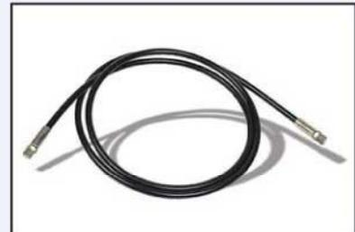
Flexible haute pression 700 Bar équipé de raccords rapides à billes (1 mâle à 90° à brancher sur le groupe permettant d'obtenir un raccord tournant et 1 femelle à verrouillage de sécurité).
