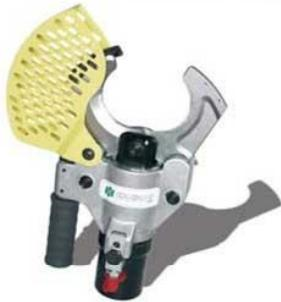
La tête de coupe-câbles XCI 95 se connecte à un groupe hydraulique 700 bar, par flexible et coupleurs haute-pression. Voir "groupes" - pages 86>95.
