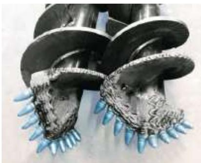
Bohrer für steinigen und felsigen Boden
