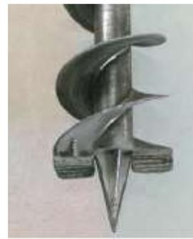
Bohrer für normalen Boden bis D=300 mm
