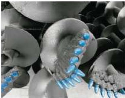
Bohrer für steinigen und felsigen Boden
