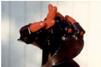
Bohrspitzen für steiniges und felsiges Gelände
