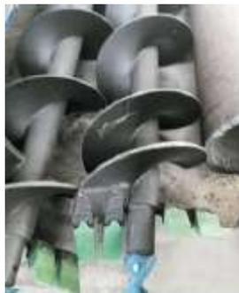
Bohrer für normalen Boden ab D=350 mm
